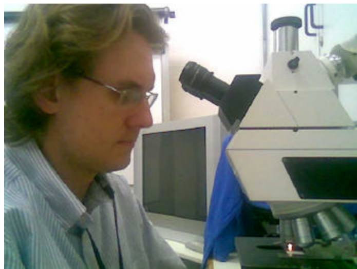
Figura 15. Imagem demonstrando microscópio acoplado a câmera digital e sistema de análise do Laboratório de Imagens e Morfometria (LIM-05)
