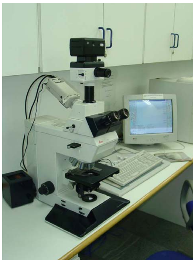
Figura 3 – Sistema de análise de imagens composto por microscópio óptico Leica DMR (Leica Microsystems Wetzlar Gmb H, Alemanha) conectado a um computador tipo IBM por meio de uma câmera de vídeo JVC (JVC TK-C1380 Color Video Camera, Victor Company of Japan Limited, Japão).
