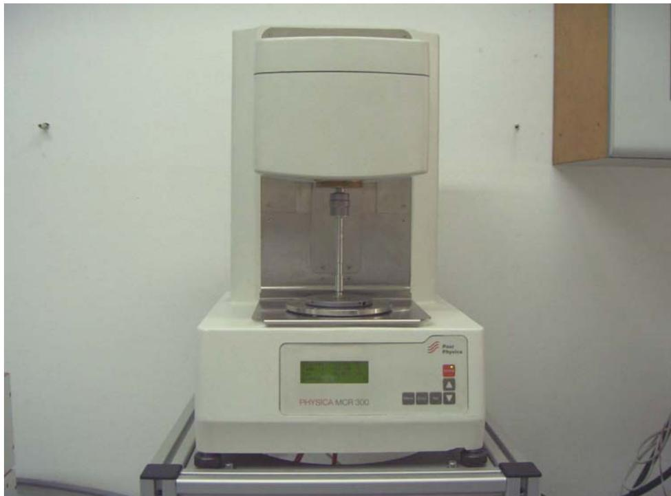
**Figura 1** – Reômetro Paar-Physica MCR 300 (Paar Physica, Stuttgart, Alemanha)
