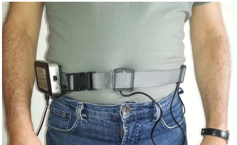
Figura 3 - Equipamento Vertiguard: observa-se o equipamento preso à cintura de um paciente - são visualizados a unidade principal e os vibradores acoplados ao cinto
