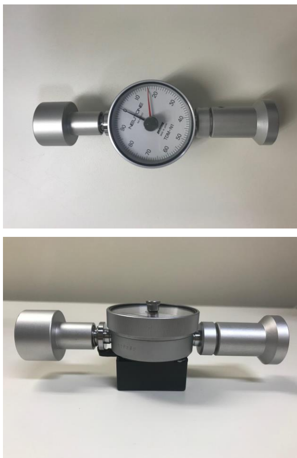
Figura 18 - Dispositivo Neutone® usado para mensurar a tensão muscular antes e após cada sessão de atendimento de AS placebo e AS terapêutico
