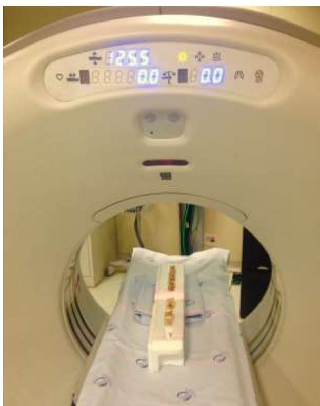
**Figura 10.** Imagem das peças implantadas e fixadas em resina de epóxi, apoiadas sobre um suporte de poliestireno e submetidas a tomografia em equipamento Discovery CT 750 HD® (General Eletric, Fairfield, EUA)
