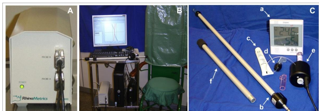
Figura 14 - Aparelho de rinometria acústica e rinomanometria da marca Rhinometrics SRE2000, acoplado a um computador. (A) aparelho gerador de ondas sonoras para a realização da rinometria acústica. Tal equipamento também realiza a rinomanometria. (B) equipamento gerador de ondas sonoras acoplado a um computador e (C) Equipamentos relacionados ao aparelho (a) controle de temperatura e umidade por meio do higrometro/termômetro da marca Oregon Scientific, (b) haste emissora de ondas sonoras para a realização da rinometria acústica, (c) gel selador, (d) adaptador nasal rosa para a narina direita (e) adaptador nasal azul para a narina esquerda, (f) equipamento para a realização da rinomanometria e (f) haste de calibração
