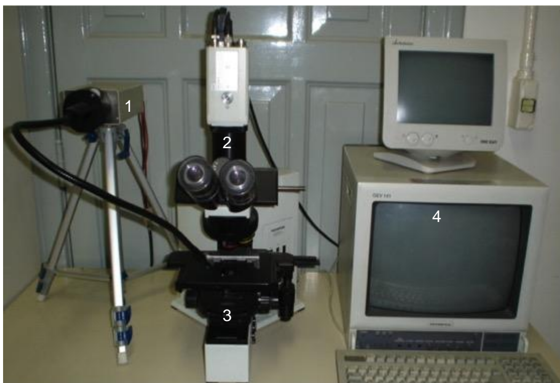
Figura 5: Equipamento usado no Laboratório de Poluição Atmosférica para mensuração da FBC das CNMs: (1) Estroboscópio; (2) câmera filmadora; (3) microscópio óptico; (4) monitor.
