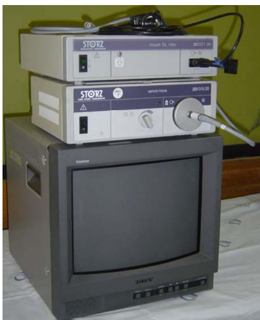
Figura 3: Sistema de vídeo-documentação utilizado durante as disseções de cadáveres. De cima para baixo: cabo de fibra ótica e cabeçote tricam encontram-se sobre a microcâmara tricam. A seguir observam-se a fonte de luz xenon e o monitor.
