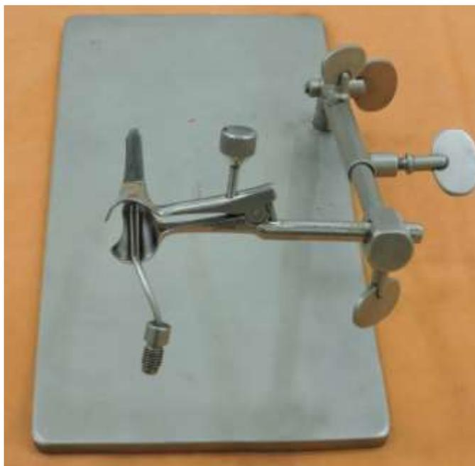
**Figura 5** - Laringoscópio adaptado para laringe de coelhos (visão anterior), acoplado ao seu suporte (base).
