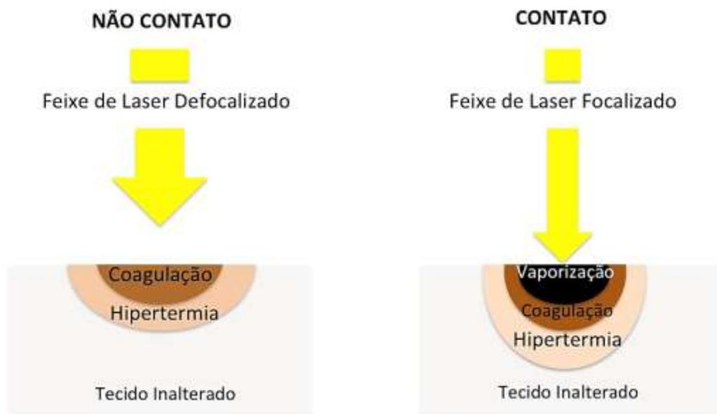
**Figura 3** – Diferença entre os efeitos teciduais provocados pelo laser em modo não contato (coagulação) e contato (vaporização coagulação).
