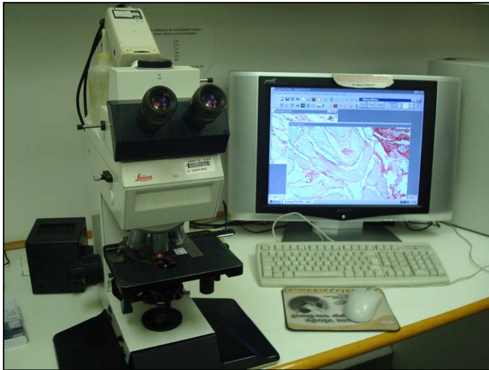
FIGURA 2 - Foto do analisador de imagem, Software Image-Pro® Plus 4.1 for Windows®, conectado a uma câmera digital acoplado a um microscópio de luz.
