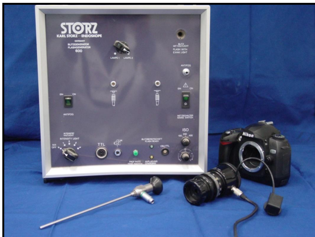
Figura 8 – Ilustração do sistema de iluminação e flash TTL da Karl-Storz, câmera fotográfica Nikon e acoplador para endoscópio utilizados para documentação fotográfica das disseções.
